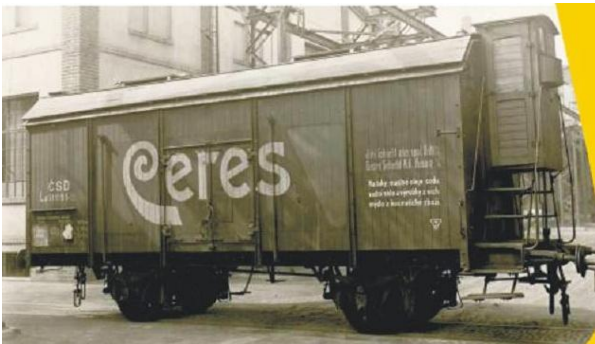
Dvounápravový chladiřenský vůz ČSD Lp 511195 na tuky, mastné oleje, sodu, vodní sklo a výrobky z nich, mýdlo a kosmetické zboží. Domovská stanice: Střekov Schichtovy závody. Rok 1931 až 34.
